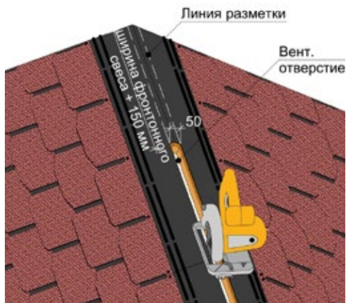
Рис.6 Устройство отверстия в крыше.
